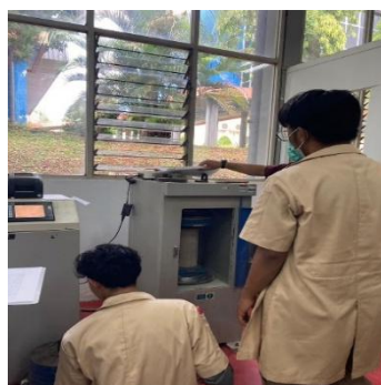
Gambar 5. Pengujian Kuat Tekan Beton
