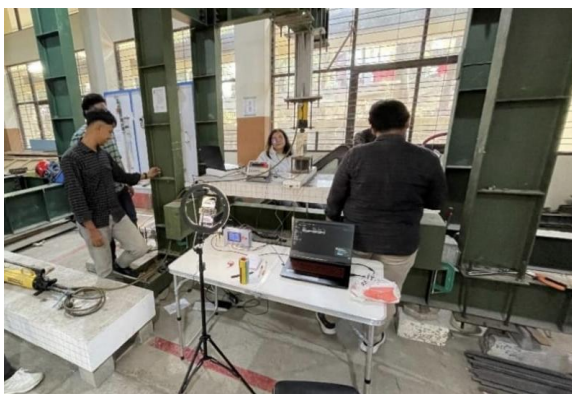
Gambar 6. Pengujian Lentur Balok
