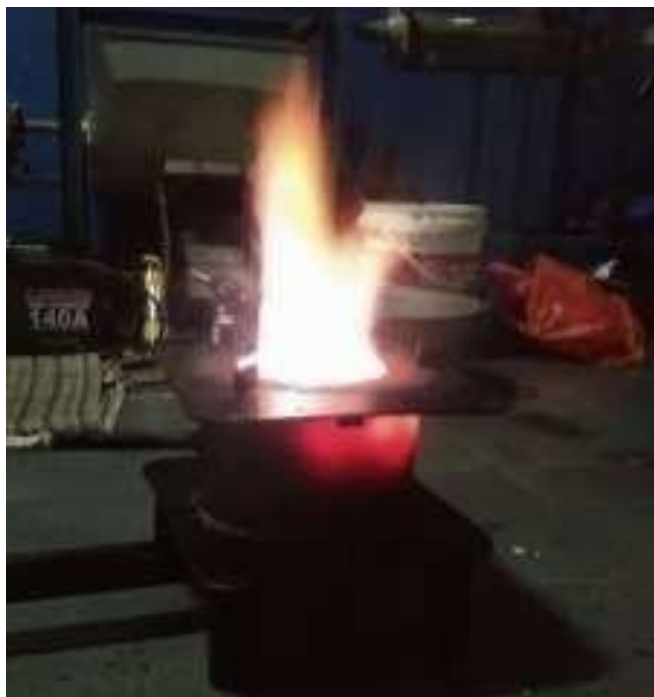
Gambar 6. Nyala api pada variasi kecepatan 3.16 m/s.
