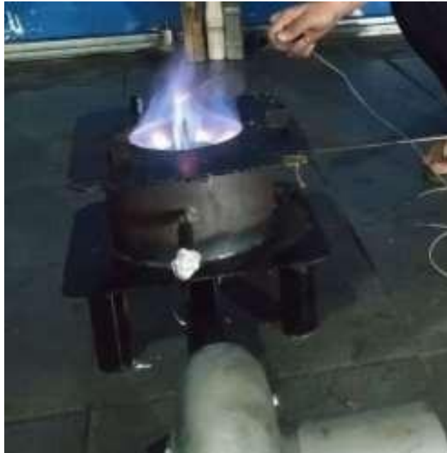
Gambar 4. Nyala api pada variasi kecepatan 2.16 m/s
