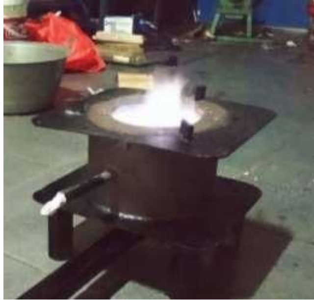
Gambar 3. Nyala api pada variasi kecepatan 1.66 m/s
