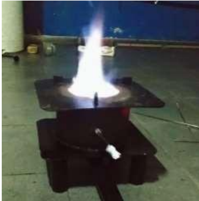
Gambar 5. Nyala api pada variasi kecepatan 2.66 m/s
