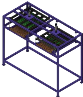
Gambar 7. Desain 3D alat pemotong tahu Gambar 8. Prototipe alat pemotong tahu
