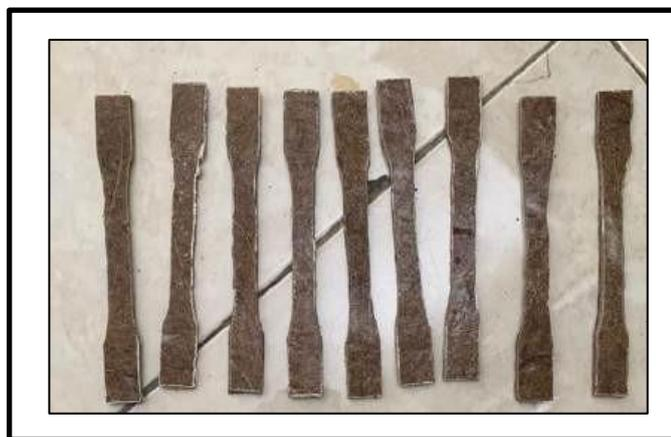
Gambar 1. Hasil Manufaktur Spesimen Uji Tarik Komposit Hybrid
