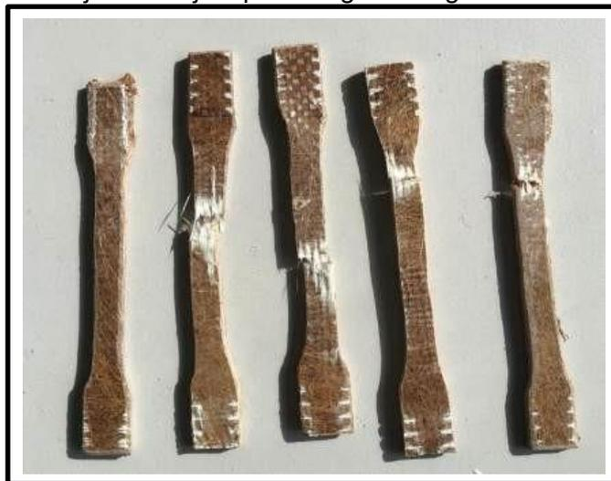
Gambar 3. Hasil Uji Tarik Spesimen Komposit Hybrid
