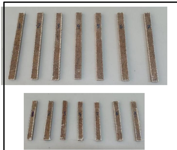
Gambar 2. Hasil Manufaktur Spesimen Uji Tekuk (Atas) dan Uji Impact (Bawah)
